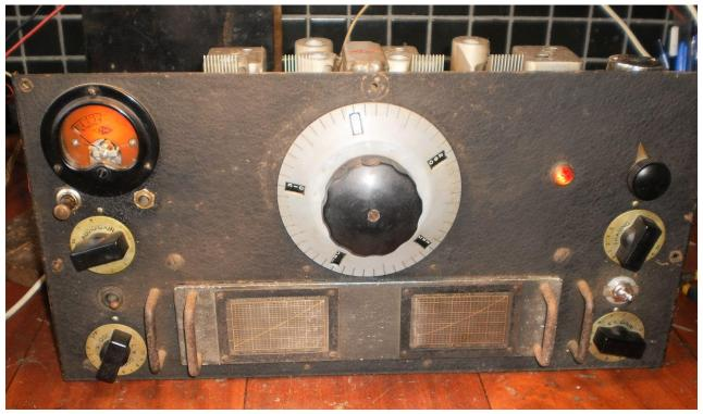
O HRO do Henrique tem as gavetas para 1.7 a 4 MHz; 3.5 a 7.3 MHz; 7 a 14.4 MHz e 14 a 30 MHz. Com a ínfima antena do apartamento deste restaurador - que não é radioamador, a melhor sintonia de emissoras de OC se deu na faixa de 3.5 a 7.3 MHz.
